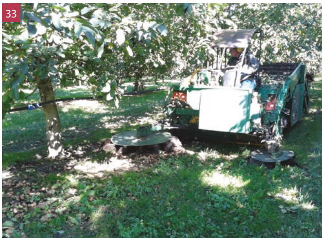
Fig. 33 - Raccattrice semovente della Monchiero (CN) in opera nel noceto. La macchina provvede ad andanare, sollevare e trasferire nell'apposita tramoggia le noci cadute terra naturalmente o a seguito del precedente passaggio del vibratore di tronco.
