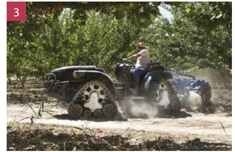
Fig. 2 - Il modello Sky Jump della lombarda BCS adotta la soluzione con cingoli a nastro gommato sull'assale posteriore. La soluzione tecnologica garantisce elevata trazione e stabilità anche nei terreni scoscesi, a vantaggio della sicurezza dell'operatore.
