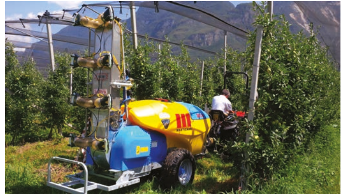
Fig. 23 - Nebulizzatore carrellato della Martignani in opera su meleto allevato a fusetto. La macchina sfrutta i campi elettrostatici per migliorare l'uniformità di bagnatura delle chioma degli alberi.
