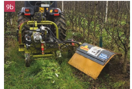
Fig. 8 - Trinciaerba interfilare portata della ditta Facma (VT) provvista di disco interfilare a coltelli e tastatore per il rientro meccanico a molla.
