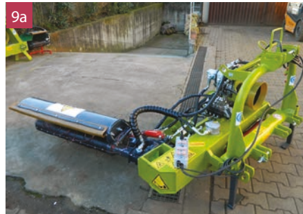
Fig. 8 - Trinciaerba interfilare portata della ditta Facma (VT) provvista di disco interfilare a coltelli e tastatore per il rientro meccanico a molla.
