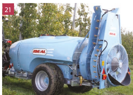
Fig. 20 - Il nebulizzatore Easy Vario realizzato dalla Tifone con inversione tra ventola e serbatoio, oltre a raccogliere meno detriti, sfrutta l'aria prodotta dall'avanzamento della macchina stessa ed elimina il cardano sotto il serbatoio, con vantaggi in termini di manovrabilità. Infine, l'elica a passo variabile permette di adeguare quantità e orientamento dell'aria prodotta a seconda della vegetazione da trattare.
