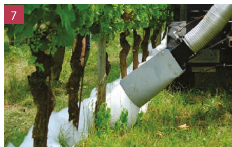
Fig. 7 - Lo schiumone, prototipo recentemente realizzato dalla piacentina Tecnovitc, si propone di diserbare il sottofila sfruttando un film schiumogeno di origine vegetale, il cui calore (70 °C) determina il disseccamento a seguito della precipitazione della componente proteica delle malerbe.
