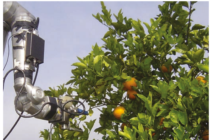
Fig. 24 - Braccio robotico autonomo al lavoro nella raccolta selettiva degli agrumi (Fonte: http://abe.ufl.edu/tburks/ARMg/research%20webpage.html ).
