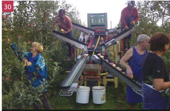
Fig. 30 - Carro semovente a 3 ruote motrici dotato di nastri per la raccolta della frutta nei bins. La velocità di raccolta è garantita dal fatto che l'operatore lavora appoggiando semplicemente la frutta sui nastri in corrispondenza della posizione di raccolta. I nastri provvederanno successivamente a riempire i bins posizionati posteriormente al carro.
