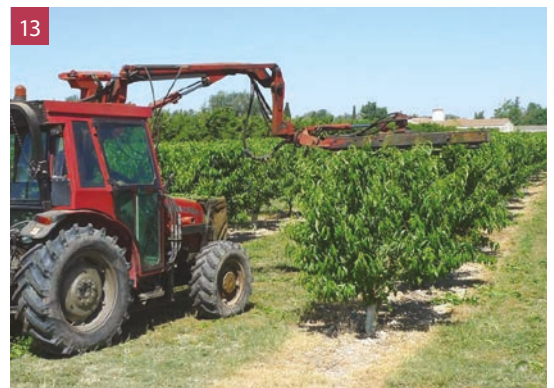
Fig. 12 - Macchina trainata provvista di utensili a dischi della Agrofer (BS) in lavorazione contemporanea lungo due sottofilari.
