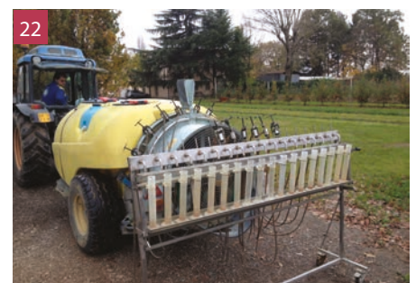
Fig. 20 - Il nebulizzatore Easy Vario realizzato dalla Tifone con inversione tra ventola e serbatoio, oltre a raccogliere meno detriti, sfrutta l'aria prodotta dall'avanzamento della macchina stessa ed elimina il cardano sotto il serbatoio, con vantaggi in termini di manovrabilità. Infine, l'elica a passo variabile permette di adeguare quantità e orientamento dell'aria prodotta a seconda della vegetazione da trattare.
