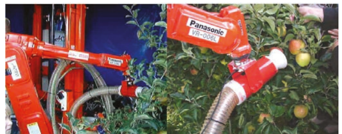
Fig. 25 - ARCO, robot sviluppato in Belgio per la raccolta autonoma delle mele. Il braccio sfrutta l'immagine acquisita da una telecamera per identificare la posizione dei frutti sull'albero (Blanke, 2010).
