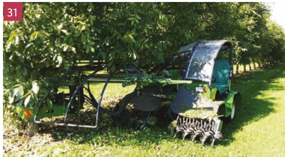
Fig. 31 - Macchina semovente (65 HP) a 4 ruote motrici provvista di testata vibrante montata su braccio telescopico laterale in opera su noceto adulto. La posizione laterale della testata rispetto al senso di marcia consente di ottimizzare i tempi di lavoro, eliminando le manovre dell'operatore.
