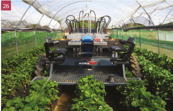
Fig. 26 - Sistema robotizzato per la raccolta delle fragole. La raccolta avviene in impianti realizzati su apposite Prode per facilitare l'esposizione dei frutti per l'analisi d'immagine che azionerà i bracci robotici i quali afferreranno i frutti idonei alla raccolta.
