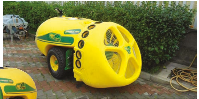
Fig. 19 - Nebulizzatore a torre (sinistra) e a ventola inclinata (destra) sono le proposte della Projet per ridurre l'aspirazione di suolo e detriti durante i trattamenti fitosanitari.
