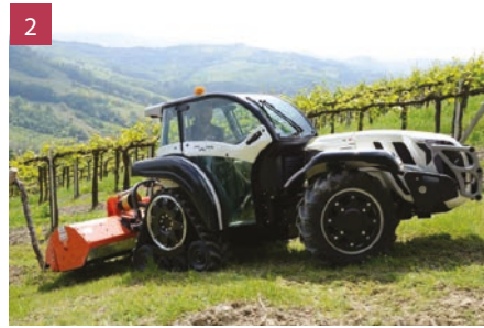
Fig. 1 - Trattrice isodiametrica realizzata dalla Pasquali, provvista di cabina e guida reversibile.
