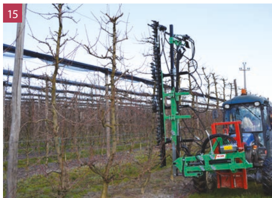
Fig. 14 - Esecuzione della potatura invernale del pescheto alveolato a parete tramite barre falciatrici.
