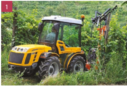
Fig. 1 - Trattrice isodiametrica realizzata dalla Pasquali, provvista di cabina e guida reversibile.
