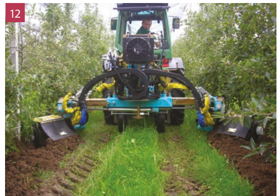
Fig. 10 - Tra gli utensili utilizzati per la rimozione delle malerbe lungo la fila anche le spazzole in materiale flessibile ancorate ad uno o più piatti indipendenti la cui rotazione è azionata da motori idraulici.
