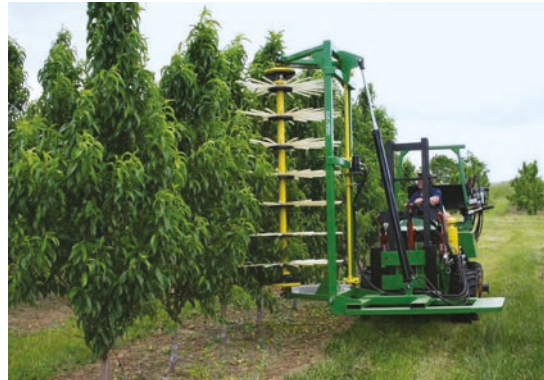
Fig. 18 - La diradatrice francese Eclairvale 2500 (sinistra) ed il "drum shaker" (destra) sviluppato dalla statunitense USDA. Due soluzioni tecnologiche per il diradamento dei frutticini sulle drupacee.
