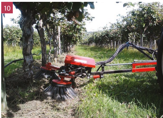
Fig. 10 - Tra gli utensili utilizzati per la rimozione delle malerbe lungo la fila anche le spazzole in materiale flessibile ancorate ad uno o più piatti indipendenti la cui rotazione è azionata da motori idraulici.
