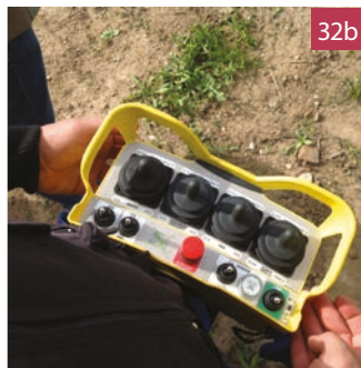
Fig. 32 - IL TR-80 della Sicma srl è una macchina trainata posteriormente ed è provvista di braccio telescopico al quale si ancorano l'ombrello rovescio e la testata vibrante multidirezionale (sinistra). La macchina ha una capacità di 30 piante/ora e viene controllata tramite un radiocomando (destra) azionato dall'operatore a terra. Si impiega principalmente per la raccolta di olive, mandorle, noci e pistacchi.
