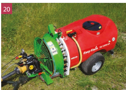
Fig. 20 - Il nebulizzatore Easy Vario realizzato dalla Tifone con inversione tra ventola e serbatoio, oltre a raccogliere meno detriti, sfrutta l'aria prodotta dall'avanzamento della macchina stessa ed elimina il cardano sotto il serbatoio, con vantaggi in termini di manovrabilità. Infine, l'elica a passo variabile permette di adeguare quantità e orientamento dell'aria prodotta a seconda della vegetazione da trattare.
